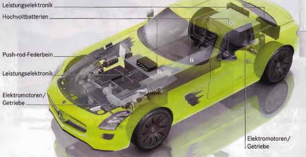
Das E-Auto erfordert eine völlig neue Gesamtkonzeption, wie die Daimler-Studie Mercedes SLS AMG E-Cell erahnen lässt. Auch in den Anfängen der Benziner war es so: Irgendwann ließen sie das Kutschen-Design hinter sich... Bild: Daimler
