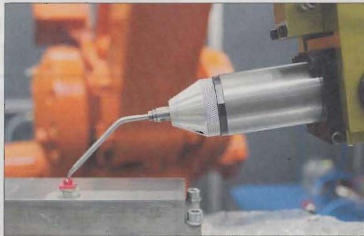
Geradlinige Schleifbearbeitung eines gefrästen Werkstücks durch einen Roboter.
