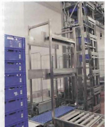
Das Behälterstapelgerät der MFI AG entspricht den Hygienic-Design Richtlinien und besteht, ebenso wie die Beladeinheit, komplett aus Edelstahl.
